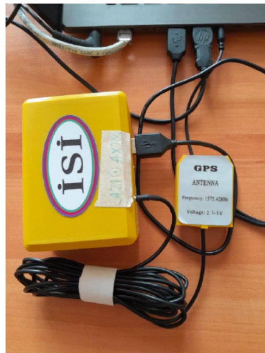
Рис. 2. Апаратний блок, що містить сенсорний модуль MPU-6050
